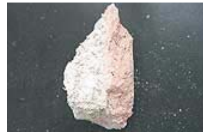
Magnesiaestrich (hellbeige; MKW-haltig) unter hellrotem Estrich
